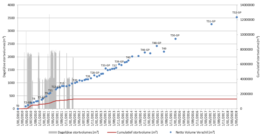
Figuur 4-7: Verloop van het dagelijks en cumulatief volume gestort materiaal en het volumeverschil op basis van de peilingen (ten opzichte van de beginsituatie) voor de complete stortzone aan de Rug van Baarland.
